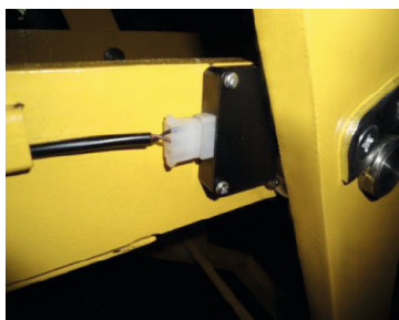
Figure17 interrupteur fin de course supérieur
